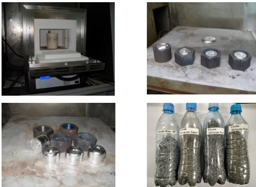
Рисунок 2.1 – Приготовление активированных сплавов алюминия (Rau-85, Al : сплав Дарсе, Al: сплав Розе, Al : сплав Вуда)
